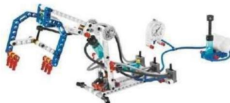
*Рычажный подъёмник.* Простое устройство с одним пневмопереключателем. Исследуется работоспособность подъёмника, то есть, какую массу и на какую высоту он способен поднять (какой нужен насос, чтобы создать требуемое давление).
